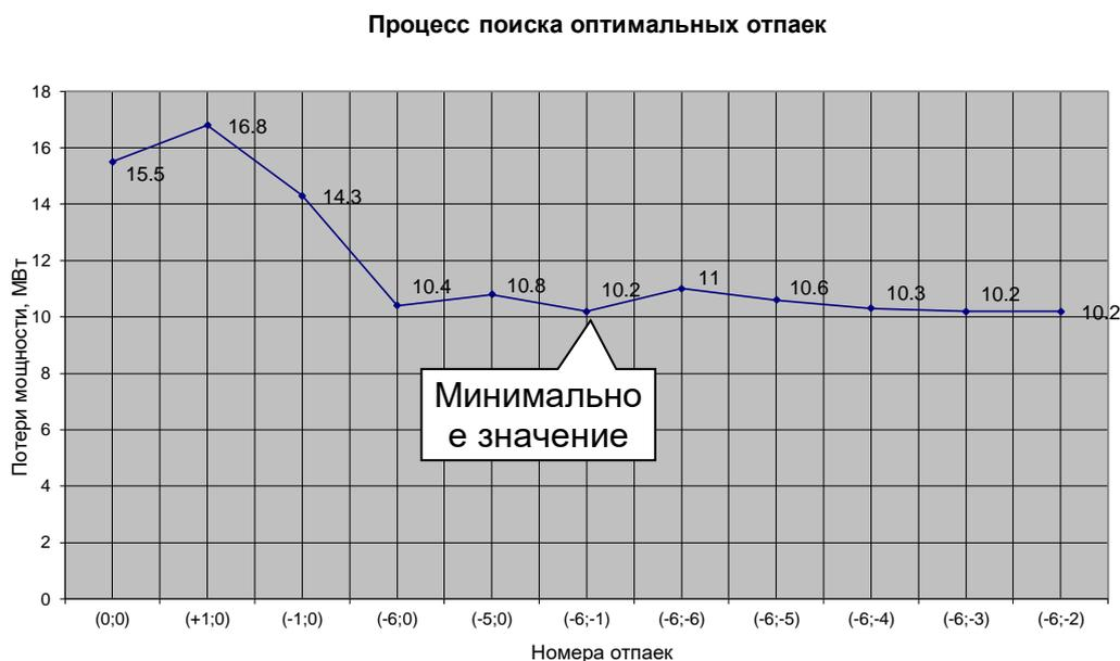
Рисунок 8 - Диаграмма поиска оптимальных отпаяк трансформаторов Т1 и Т2
